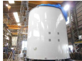
補給水タンク
